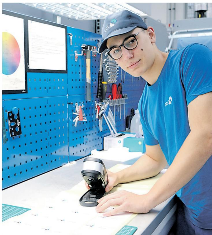
Mit einem Farbmessgerät prüft Tobias Wismer die Qualität des Drucks.
